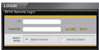
Sélectionnez entre les modes REMOTE WATCH (Surveillance via Internet) et REMOTE SEARCH (Recherche via Internet). Entrez l'ID (Code) (standard: admin) et le PASSWORD (Mot de Passe), en cliquant sur le bouton [LOGIN] (ouvrir session) la connexion sera effectuée à l'aide du mode sélectionné.
