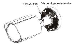
Positionnez la caméra de façon à obtenir le meilleur champ de vision et ensuite serrez les vis de réglage de tension du support/caméra (2 vis).
